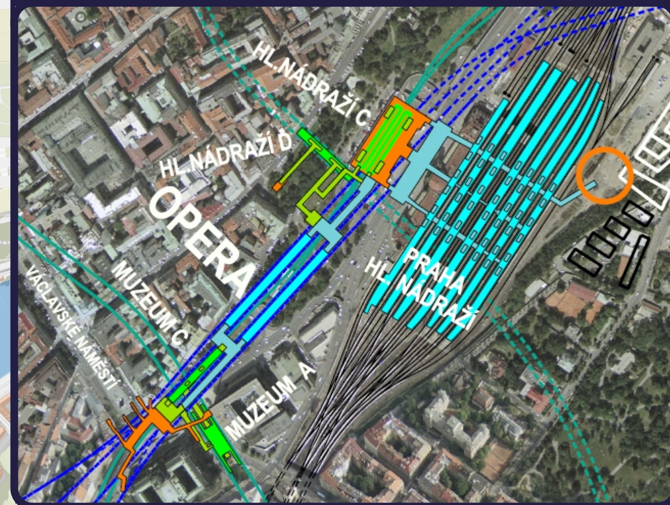
Detail řešení přístupu do stanice Praha-Opera
